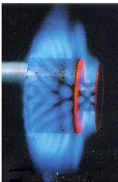
Les modèles de brûleur gaz à air pulsé se différencient pas la forme de la tête de combustion. On retrouve ainsi des tubes percés de trous ou de fente, des tubes à gaz, des dispositifs tourbillonneurs, des accroche-flammes à fentes ou trous, ...
