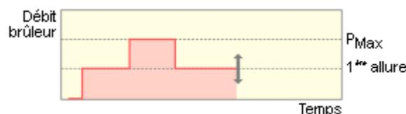
Deux possibilités constructives sont exploitées dans les brûleurs 2 allures :
