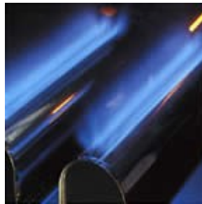
Flamme d'un brûleur atmosphérique à prémélange, en forme de trèfle.
