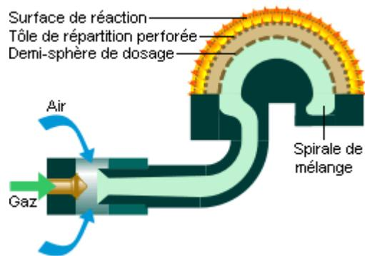
*Brûleur hémisphérique radiant (existe aussi en version plane) : le mélange air-gaz réparti sur la surface de combustion avec une vitesse très faible puisque cette surface est nettement plus importante que pour les brûleurs atmosphériques traditionnels. Le mélange brûle alors directement, pratiquement sans flamme visible et cède une partie de sa chaleur directement à l'élément réfractaire.*
