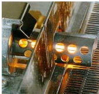
Electrode incandescente d'allumage d'un brûleur atmosphérique.
