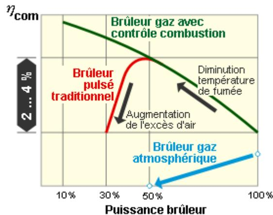
*Evolution du rendement de combustion des brûleurs actuels en fonction de la modulation de sa puissance.*
