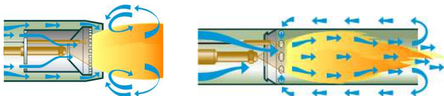
Brûleurs Low NO x (ici en version fuel) basés sur le principe de recirculation : la re-circulation s'effectue dans le foyer à hauteur de la tête de combustion. Une zone de dépression aspire à nouveau les gaz de combustion et les mélange à la flamme. La re-circulation peut également être externe.
