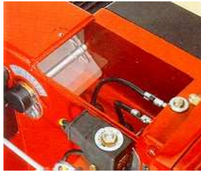
Registre d'air et son réglage, placés sur le refoulement du ventilateur.
