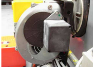
Clapet d'obturation écarté (ouverture et fermeture) par servomoteur.
