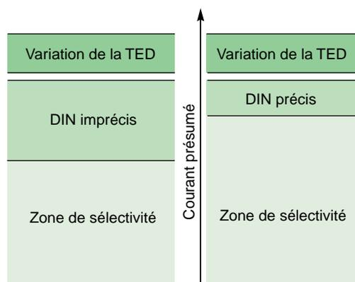
**Fig. 15** : influence de la précision de la chaîne de mesure de courant d'un disjoncteur sur la sélectivité.
