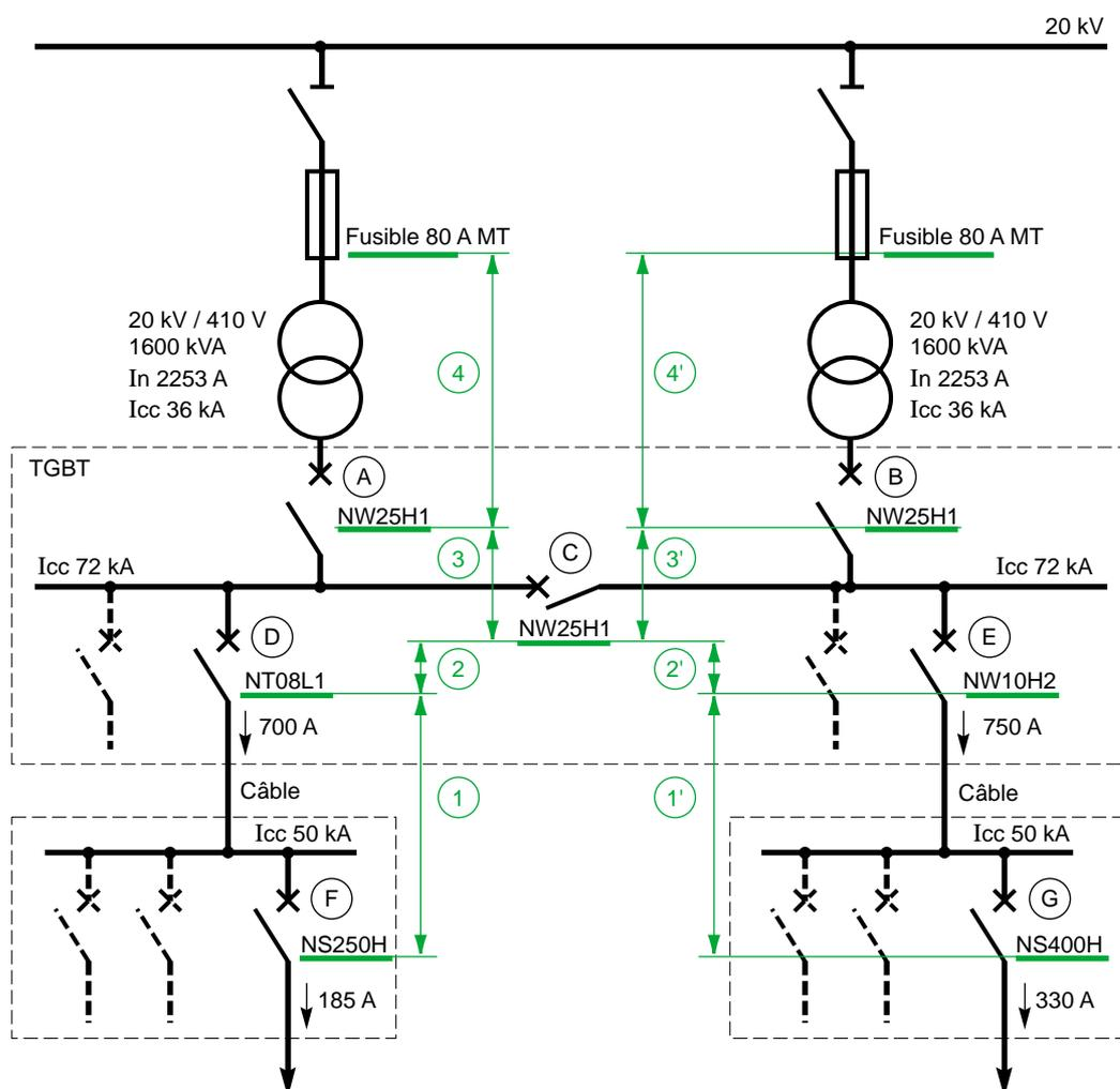
**Fig. 20 :** 1er exemple d'installation (avec transformateurs MT/BT 1600 kVA) avec indication de l'ordre d'étude de sélectivité.
