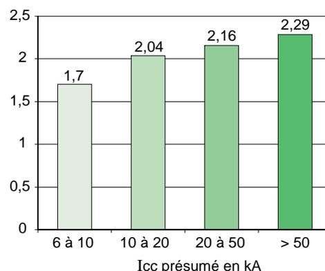
**Fig. 11** : coefficients d'asymétrie en fonction du courant efficace présumé selon la norme CEI 60947-1.
