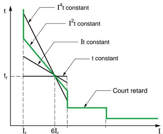
**Fig. 14** : courbe de déclenchement « IDMTL » d'un disjoncteur.
