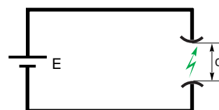
Fig. 2 : l'arc électrique et l'influence du champ E/d .
