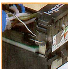
Prise RJ45 FTP (non blindée) : connecter le fil de masse (drain)
