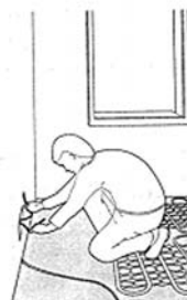
4 Raccordement des liaisons froides (sans tubage en position horizontale et première finition électrique des éléments chauffants).
