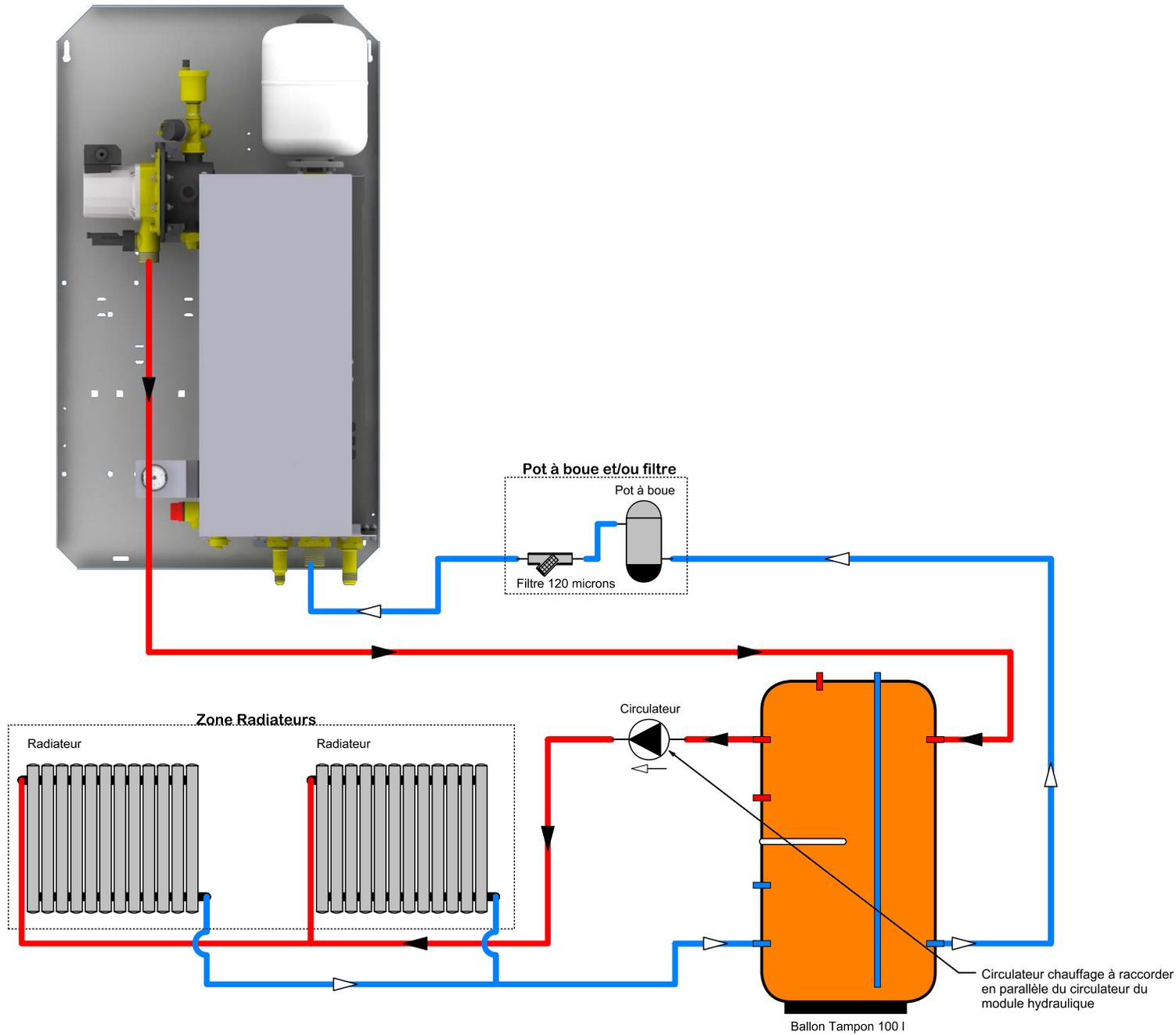
APPLICATION : Installation sur 1 zone de radiateurs avec mise en place d'un ballon tampon.
