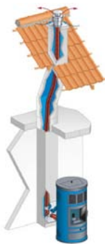
Raccordement à un conduit de fumée avec tubage
